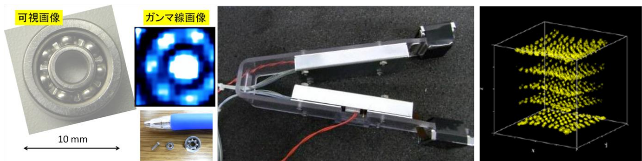
図 3: (左)MPPC アレー+微細シンチで撮像したベアリング画像 (中) 術中に触診可能な小型ピンセット型 PET カメラ。解像度で約 1mm を達成 (右) ガンマ線の 3 次元吸収位置(DOI)測定
